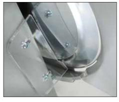
**Deflector de la loncha:** con la máxima longitud para su seguridad y fácilmente desmontable para su limpieza.
