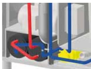
El sistema **W.A.G.P.** integrado en los modelos ATA.10/11 ofrece excelentes resultados de aclarado, ya que dispone de una reserva de agua incorporada que, a través de una bomba, asegura una presión y un caudal constantes independientemente de la presión de alimentación. Previene los reflujos en caso de baja presión en la red. Esto garantiza el cumplimiento de las normativas higiénicas europeas (HACCP).
