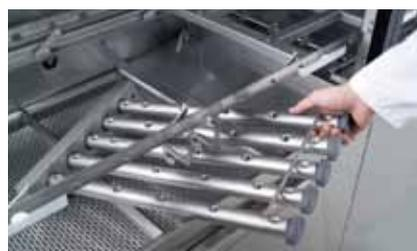
Brazos de lavado en acero inox fácilmente extraíbles para una limpieza rápida. Tanque con bordes redondeados e inclinado para asegurar el drenaje de agua sucia.
