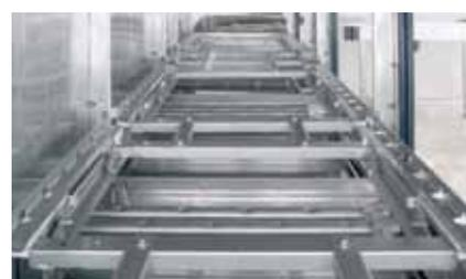
Estructura robusta totalmente de acero inoxidable 18/10 AISI 304. Puerta robusta con control de balance.
