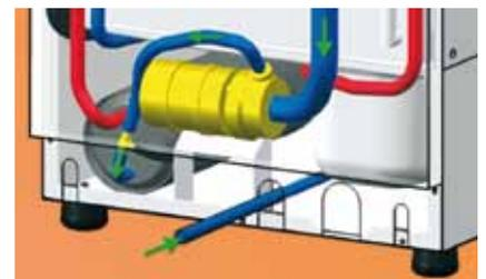
Resultados de aclarado perfectos, gracias al sistema **WAGP**. Con un tanque y una bomba adicional, proporcionan la presión correcta y velocidad de flujo del agua independientemente de los valores de red.
